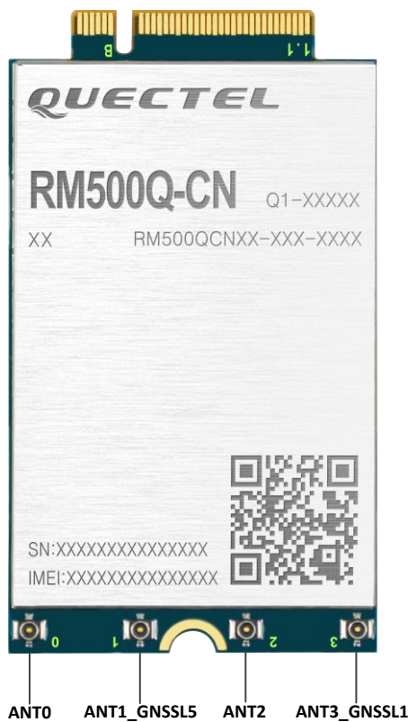
图 28：天线连接器分布示意图
